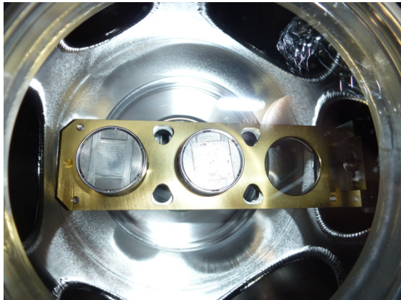
カソード3つを同時輸送する専用コンテナ
