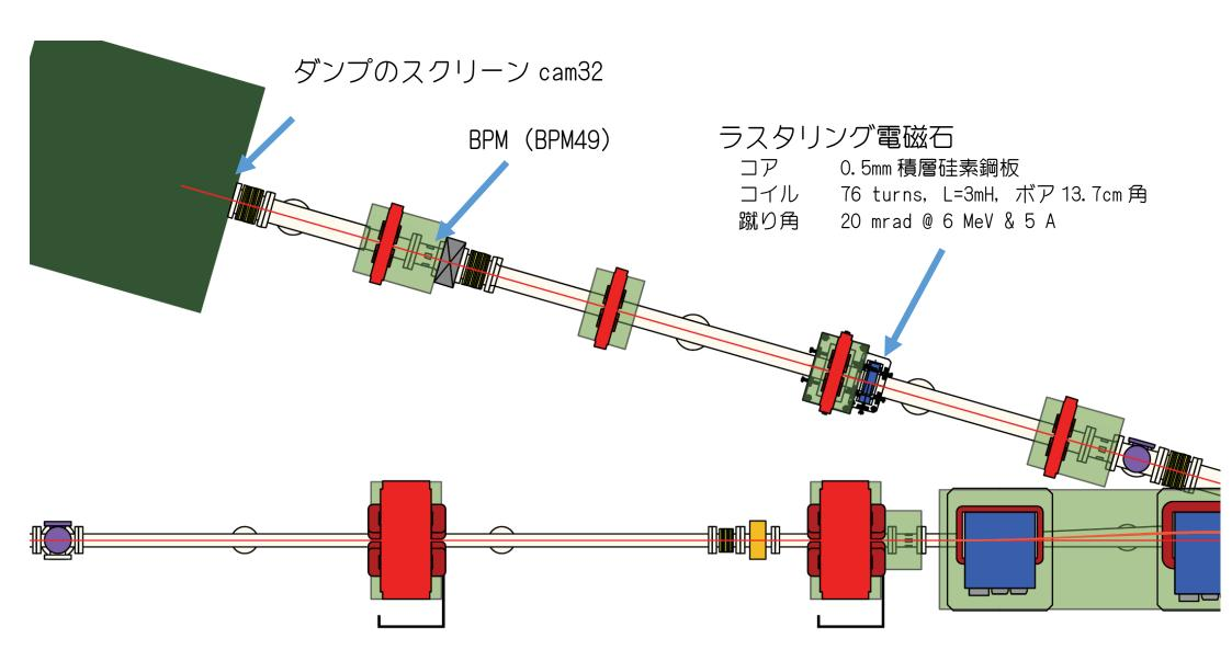
ダンプまで約3m、4極を考えなければ20mradで片側6cm振れる。 実際は4極変えたら振幅の再調整が必要。
