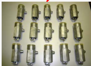
HOM(高次モード)カップラーとその構造
