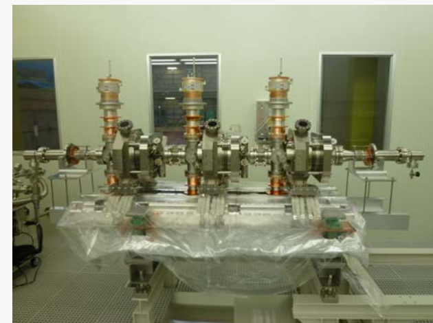
入射空洞クライオモジュールの組立
