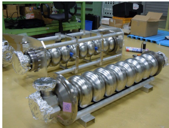
納品された2台の9セル空洞 受け入れ検査の後、EP、アニールを実施 7/20 ERL計画推進委員会
