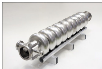
主加速部超伝導空洞
