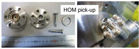
ニオブ製アンテナを京セラ製アルミナ窓、螺子(M5)でアンテナを接続する。
