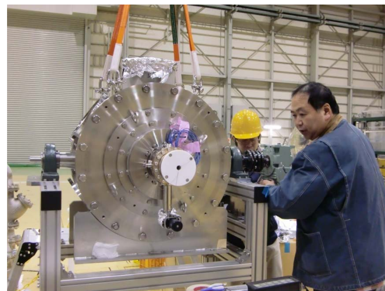
断熱槽内で柱をとり、断熱槽を回転させる。
