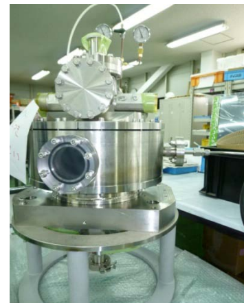
高圧ガス耐圧試験 (#5空洞)
