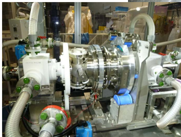
電解研磨 (#3空洞)
