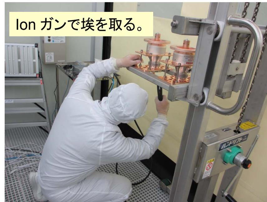
Low level測定後にcleanな環境を保持するため、超純水洗浄後に組立、洗浄後一晩乾燥。
