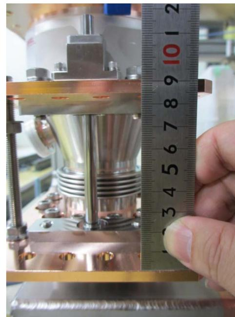
カップラーの挿入量は銅板アンカー間を測定することで算出。
