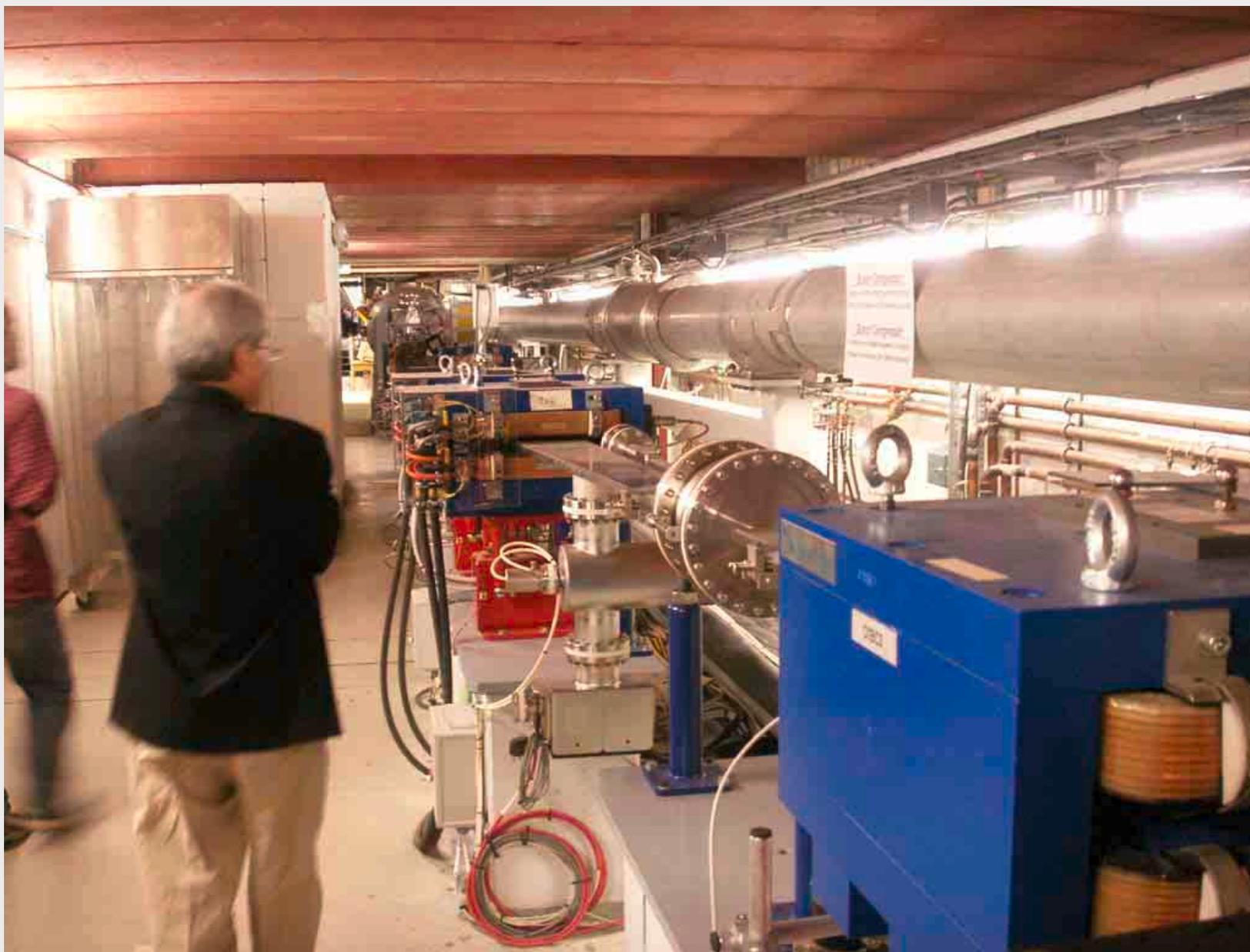
バンチコンプレッサー用シケイン(2段目)。幅広のチェンバーを使用。
