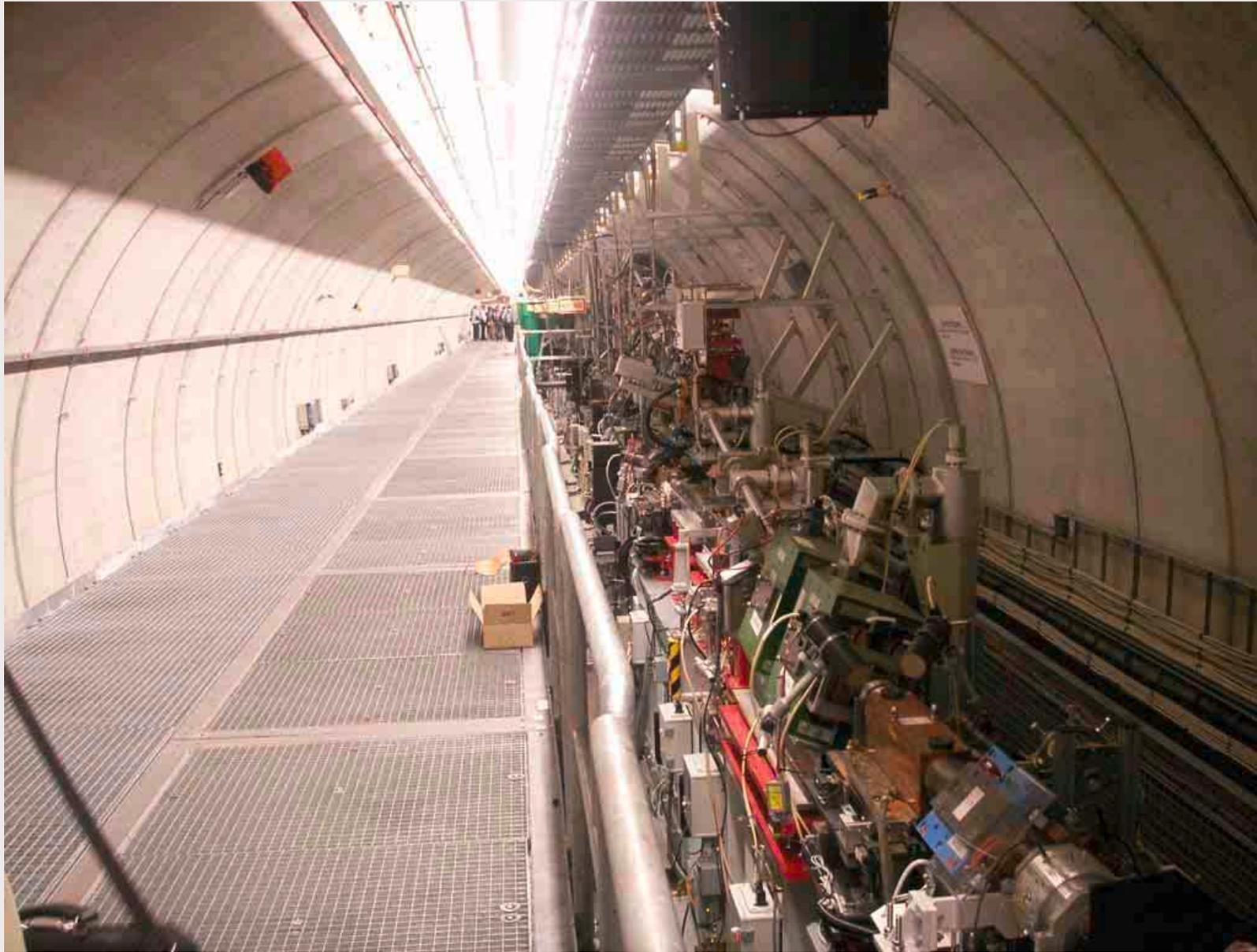
超伝導リニアックからアンジュレータまでのビーム輸送路。
