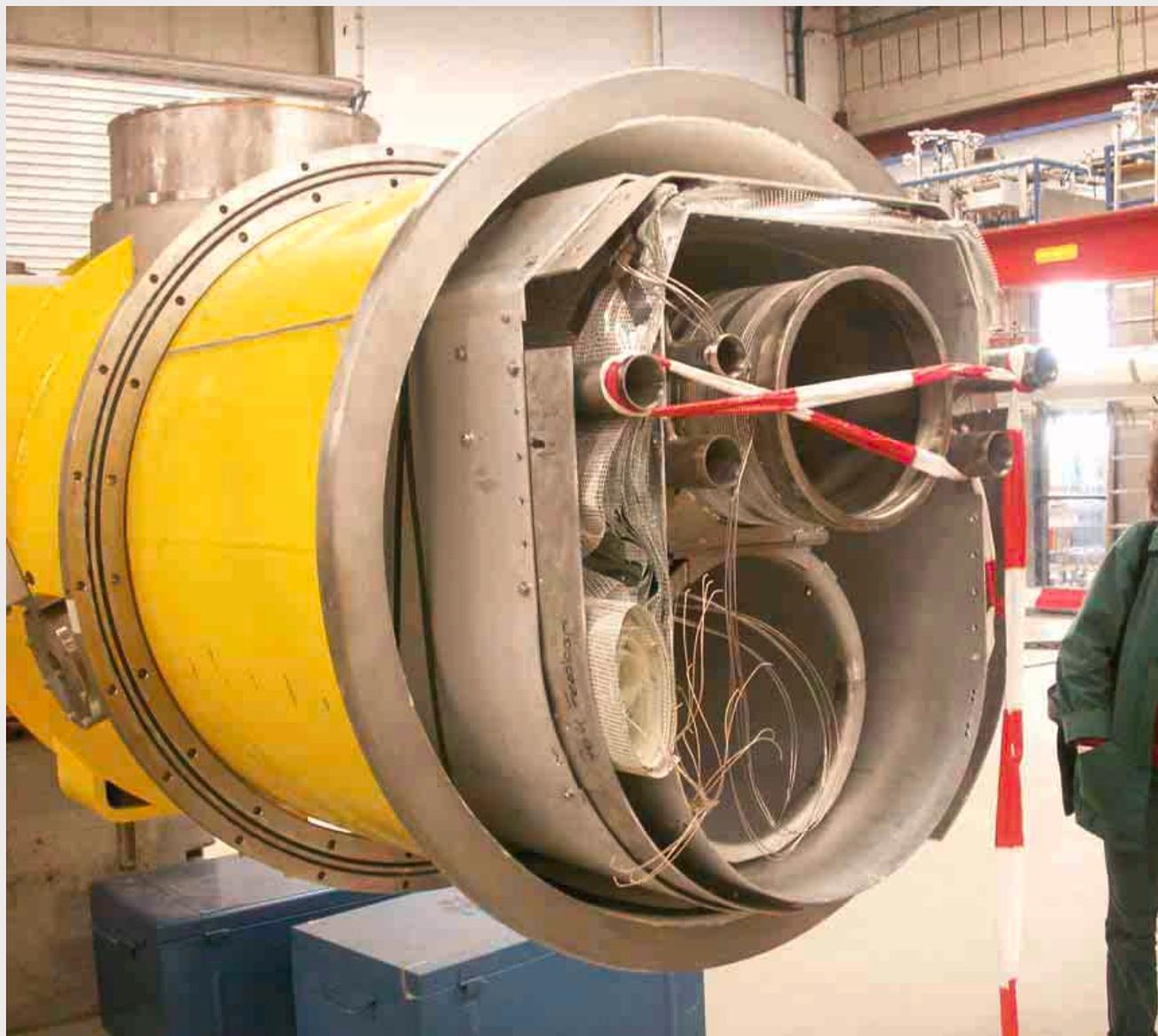
製造中のクライオモジュール。内部、下のパイプに超伝導空洞が入り、上の大きなパイプはヘリウムガスのリターン路。
