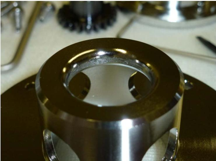
ロッドの軸と軸受部の間でカジリ発生。
