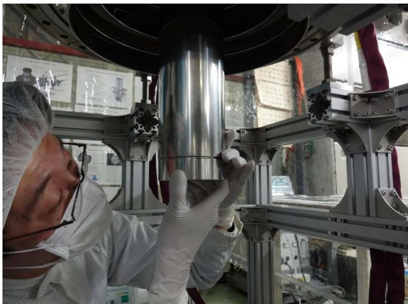
調整範囲下限でもカソード電極の位置が1mm程度高かったため、30mmの延長部品を取付けた。
