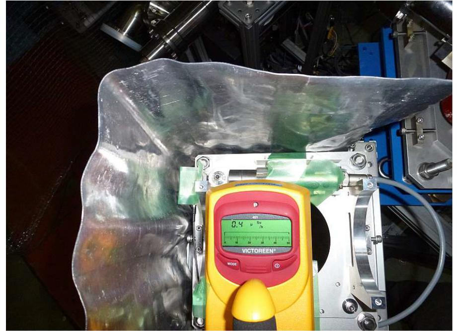
発生源から見てセンサー全体が1mm厚の鉛板で隠れるようにやや大きめの鉛板をL字状に架台の上に置く。
