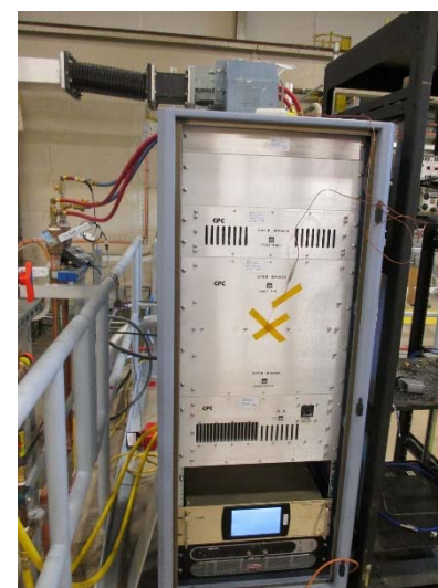
横スタンドの新たな1.3GHz Solid state amp CPCという(謎の)会社。3.9kW仕様だが、まだ、2.5kWしか出ていない。
