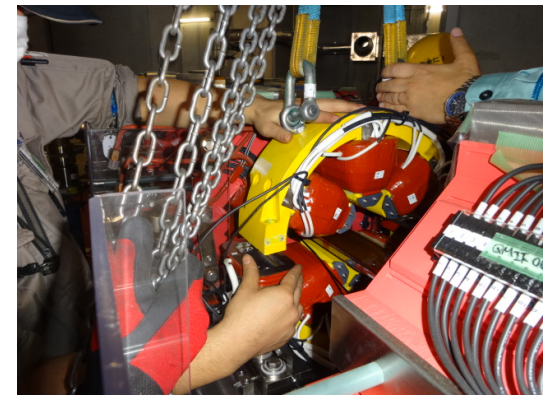
半割上部設置作業
