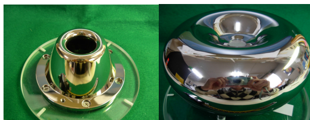
図3 : 研磨後のチタン陽極、モリブデン陰極
