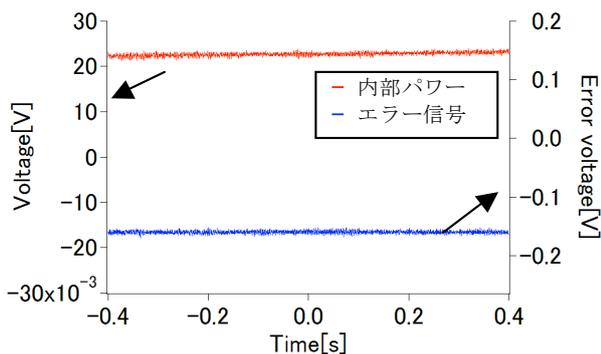
図5 ロック状態の外部共振器内部パワーとエラー信号
