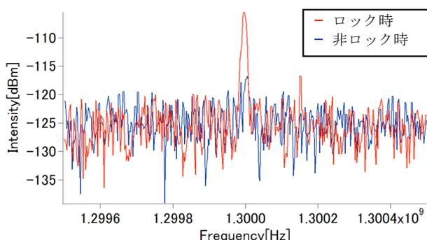
図6 外部共振器内の1.3GHz成分 PINフォトダイオードで検出した。
