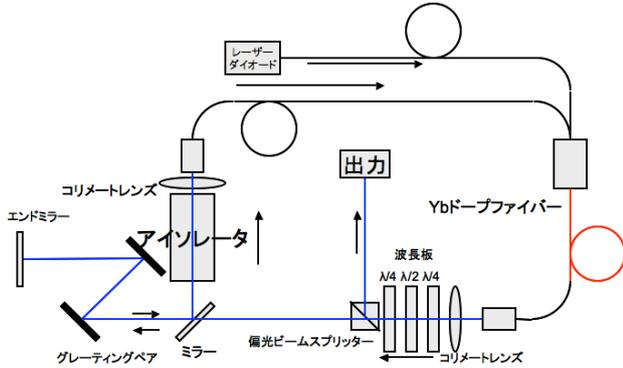
図1 100MHz Ybファイバーレーザーオシレータのセットアップ ファイバー部分を黒および赤、空中部分を青のラインで示した。
