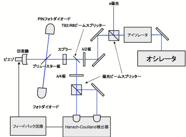
図3 1.3GHz外部共振器のセットアップ
