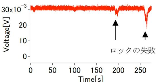
図7 外部共振器の長時間ロック (外部共振器の内部パワー。フォトダイオードで検出)
