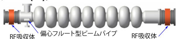
図2: 主リニアック用9セル空洞の基本設計。
