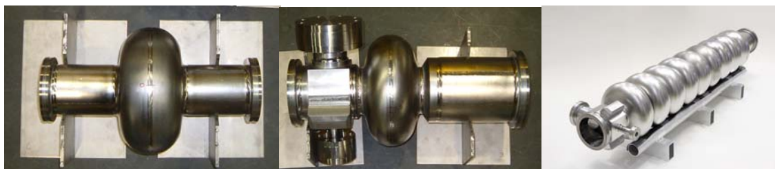
Fig.1 製作した3種類のNb空洞。(左)センターセル単空洞、(中)エンドセル単空洞、(右)9セル空洞
