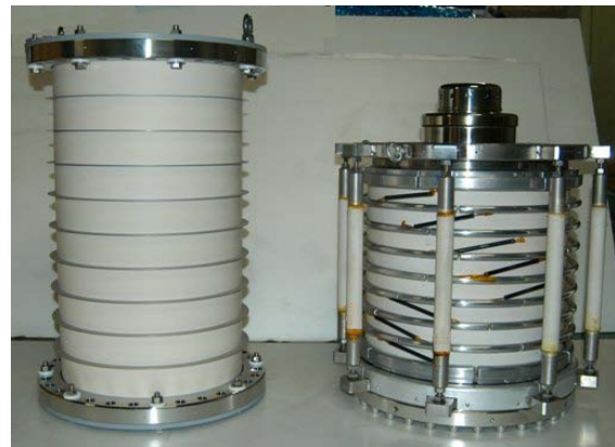
図2. JAEA高出力FEL熱電子銃用セラミック管(右側)および500kV光陰極DC電子銃用セラミック管(左側)の写真。熱電子銃用セラミック管については分割抵抗、サポートロッドが取り付けたまゝの状態である。
