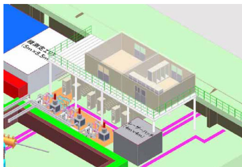
図6：東カウンターホールでのRF源(特に入射器)のレイアウト
