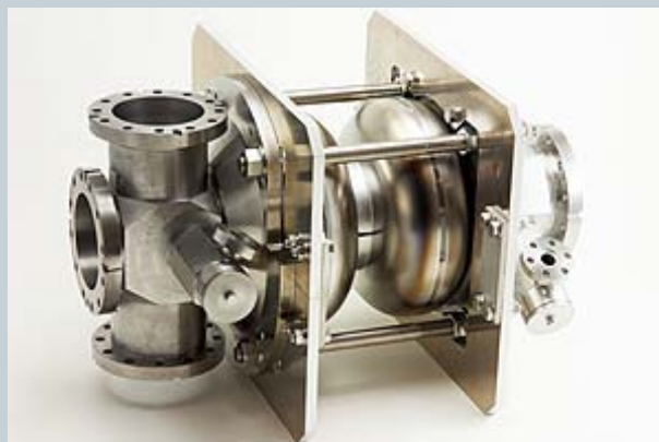
ERL 2-cell #1 Cavity 2 loop-type & 2 antenna-type HOM couplers
