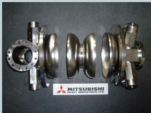
ERL 2-cell #1 Cavity 2 loop-type & 2 antenna-type HOM couplers
