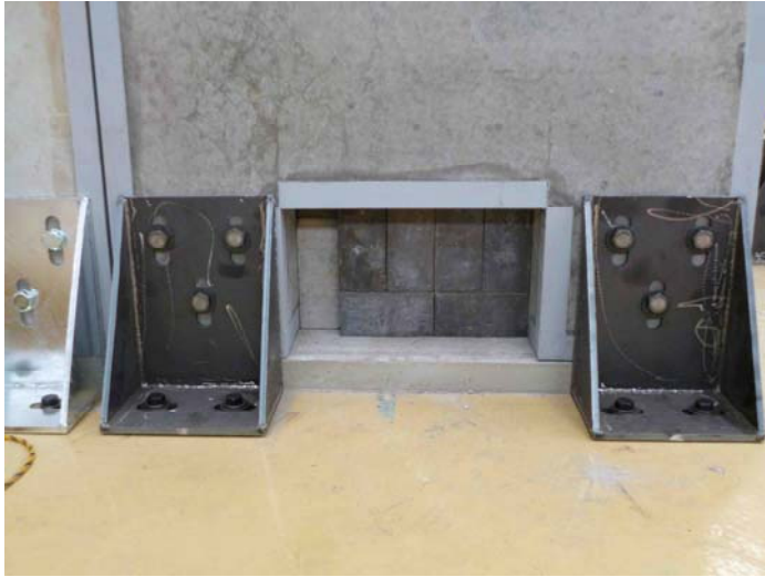
遮蔽体の貫通孔を遮蔽材で埋めてみる
