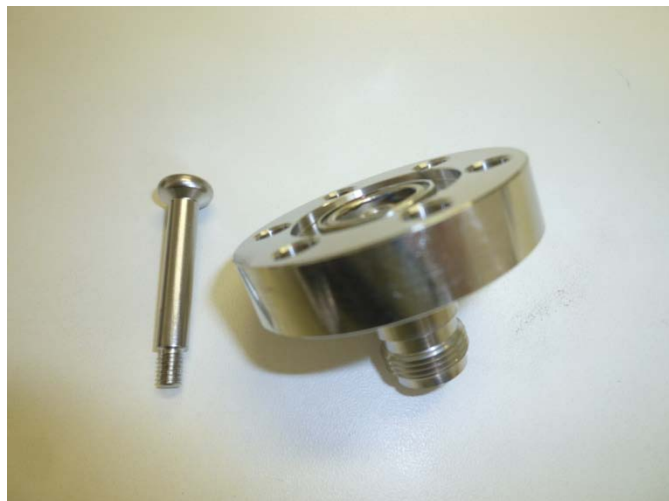
Type-0 (i.c: Kovar, o.c: Kovar)
