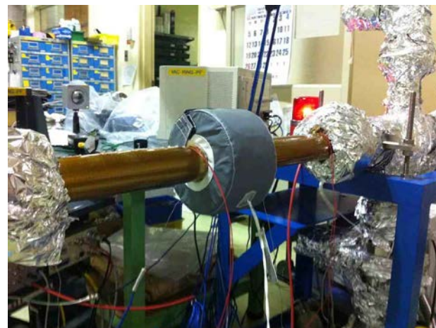
フィルムヒータによるベーキング試験
