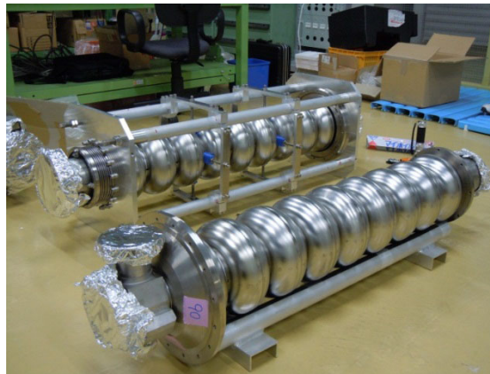
納品された2台の9セル空洞 受け入れ検査の後、EP、アニールを実施
