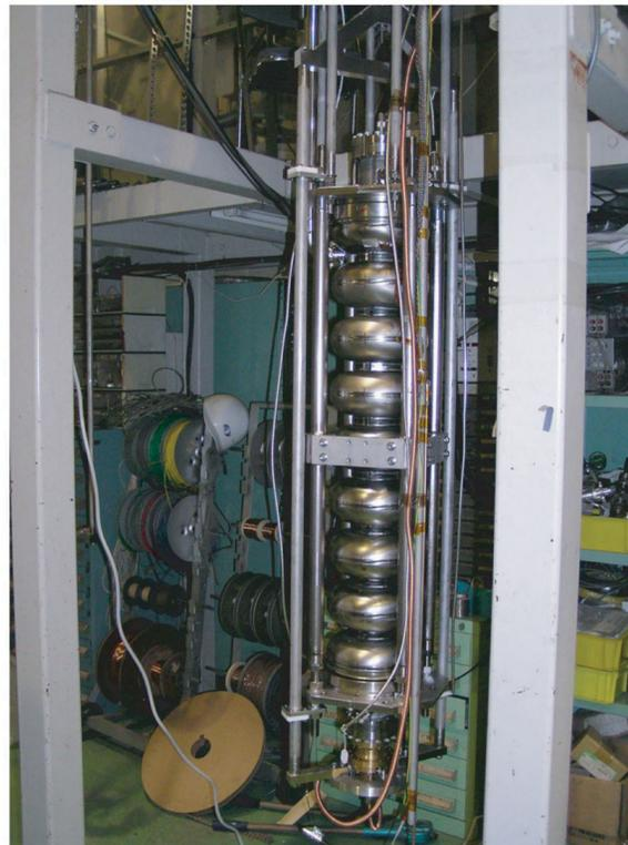
KEK のリニアコライダーの加速空洞開発グループとの協力のもと行なわれている ERL 用超伝導加速空洞の開発のようす。
