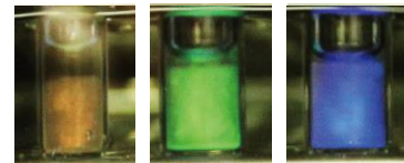
図 1. C22TAB 水溶液クラフト温度 (57 °C) 以下 40°C で現れる構造色。左から 0.25, 0.3, 0.5 wt%。
