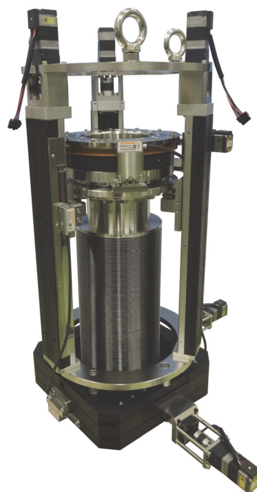
図 1 BL-13B の高分解能光電子分光装置 SES200 に取付けた高精度 XYZ トランスレータおよび高精度中空型回転導入機 [1]
