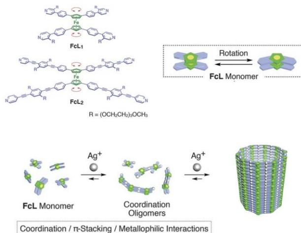
図 1 フェロセン配位子の分子構造と自己組織化的なナノチューブ構築の模式図。
