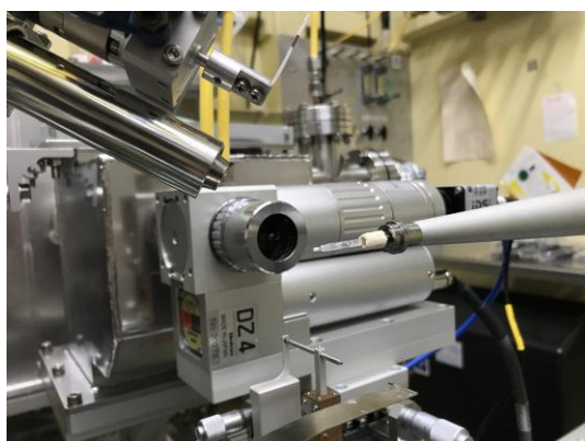
図3：石英製キャピラリを用いた X線回折測定
