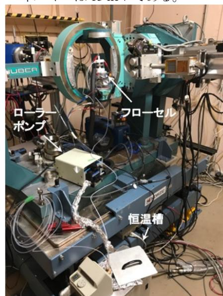
図 1 : BL-3A においてフローセル設置後の 4 軸回折計
