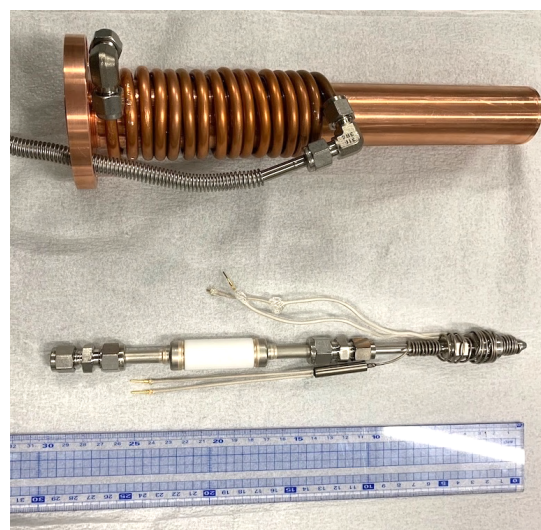
図1：分子線加熱ノズルの写真。加熱部分（下）と冷却用銅製のシュラウド（上）。
