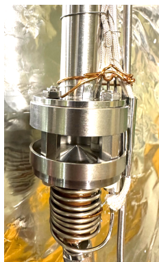
図 1：新たに上智大学で開発された加熱ノズル
