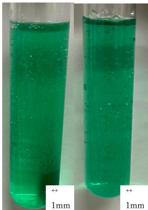
図2 塩濃度勾配法によるリゾチーム結晶 (pD7.0) 左 25mg/mL 右 30mg/mL
