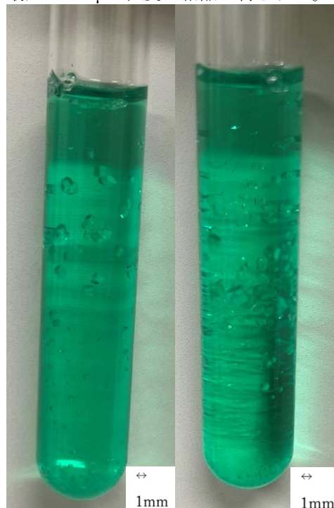
図 1 塩濃度勾配法によるリゾチーム結晶 (pH4.5) 左 25mg/mL 右 30mg/mL
