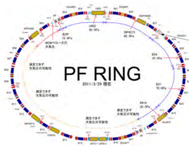
図4 震災後に測定されたPFリング一周の真空度
