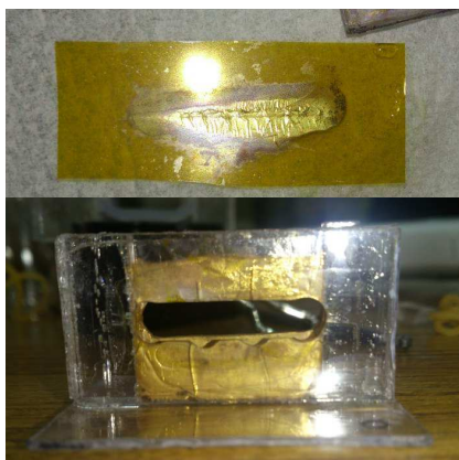
図4 親水化カーボン粒子を分散させた H Au Cl 4 水溶液に GAP 長 32 mm で白色 X 線を 10 分照射した後のカプトン窓 (上) およびアクリルセルの写真 (下)。X 線の当たっていない部位も金めっきされたような状態になっている。
