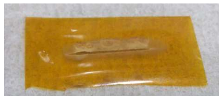
図 2 カーボン粒子無しの H AuCl 4 水溶液に、GAP 長 24 mm で白色 X 線を 24 分照射した後のカプトン窓の写真。X 線のあたったところに線状に Au メタルが堆積していることがわかる。
