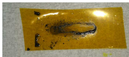
図 3 疎水性カーボンを分散させた H AuCl 4 水溶液に GAP 長 32 mm で白色 X 線を 22 分照射した後のカプトン窓の写真。カーボン粒子は着いているが、X 線のあたっていたところへの Au メタルの析出は見られない。
