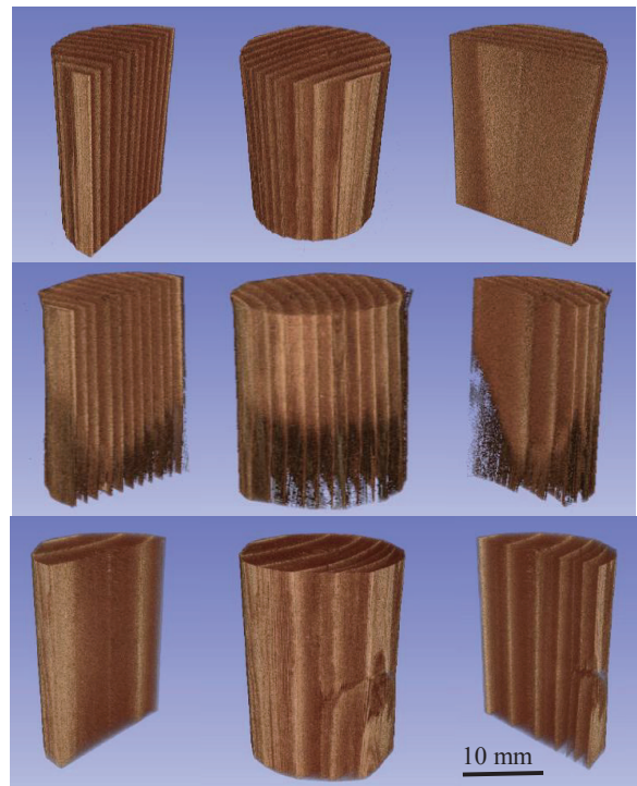
図3. CT3次元再構成図 未処理材(上)・炭化材(中)・腐朽材(下)
