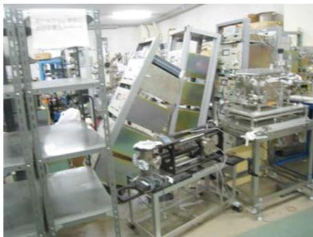
写真5 真空ポンプの電源が転倒
