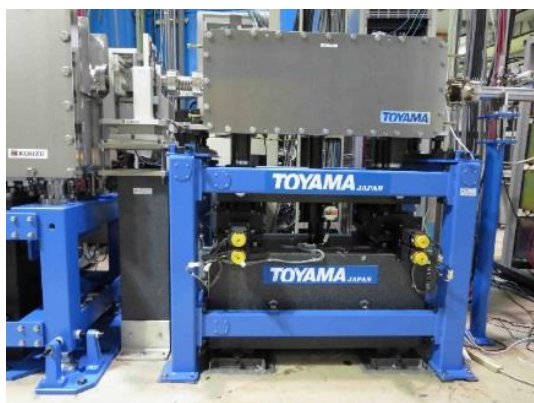
写真 4 M2 ミラーとスリット 駆動機構の架台として石定盤を使用
