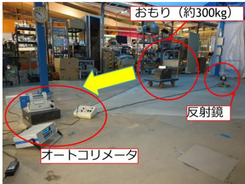
図 7：床加重変位測定の様子
