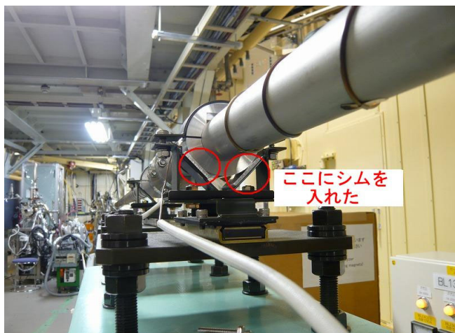
図 16 ダクトの傾け方法
