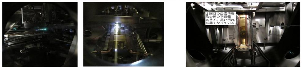
(写真) in situ炭素汚染除去中の平面鏡(M2)。0次光照射領域で酸素分子が解離し、強く発光している。
