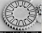
▲ワブルモーター用Ni構造体(最小ギャップ2μm) <立命館大学理工学部マイクロシステム研究室提供>
