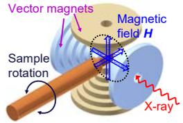
2組の超伝導マグネットを組み合わせることで、2次元的に任意の方向へ磁場を印加することが可能である。磁気異方性や、スピン分布の異方性を観測するのに用いられる。
