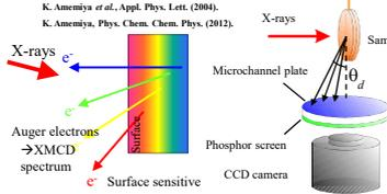
X線吸収に伴う光電子の脱出深さが電子の脱出方向によって異なるため、光電子数の方向依存性を測ることで、X線吸収およびXMCDスペクトルの深さ方向の分離が可能になる。
