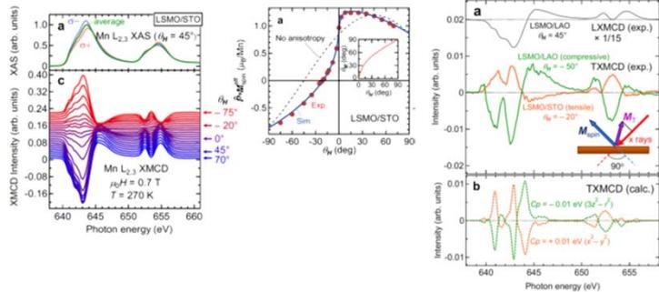
SrTiO<sub>3</sub> (STO) (001)およびLaAlO<sub>3</sub> (LAO) (001) 基板上に成長させたLa<sub>0.7</sub>Sr<sub>0.3</sub>MnO<sub>3</sub> (LSMO)薄膜に対して角度依存XMCDの実験を行った。そこから磁気双極子項M<sub>2</sub>を抽出することに成功し、その結果、基板応力が圧縮性(LAO)か伸張性(STO)かに応じて、磁気異方性だけでなくスピン分布の異方性が逆になることが明らかになった。今後は磁気異方性を示す他の強磁性薄膜に対して同種の測定を行い、磁気異方性とスピン分布異方性との関係性について明らかにしてゆく。
