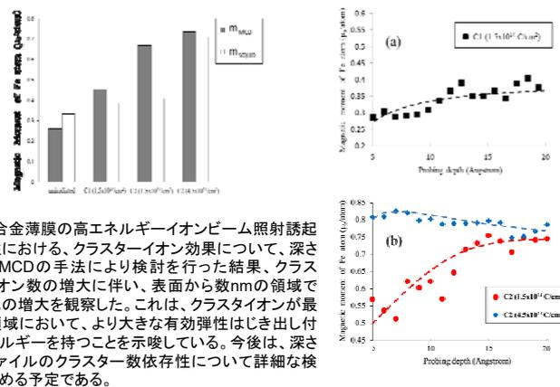
FeRh合金薄膜の高エネルギーイオンビーム照射誘起強磁性における、クラスターイオン効果について、深さ分解XMCDの手法により検討を行った結果、クラスターイオン数の増大に伴い、表面から数nmの領域での磁化の増大を観察した。これは、クラスターイオンが最表面領域において、より大きな有効弾性は引き出し付与エネルギーを持つことを示唆している。今後は、深さプロファイルのクラスター数依存性について詳細な検討を進める予定である。
