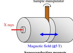
最大5 Tまでの磁場を利用することができ、磁気異方性の強い試料のXMCD測定に適している。また、多数の試料を同時にマウントできるため、組成依存性等の測定にも向いている。
