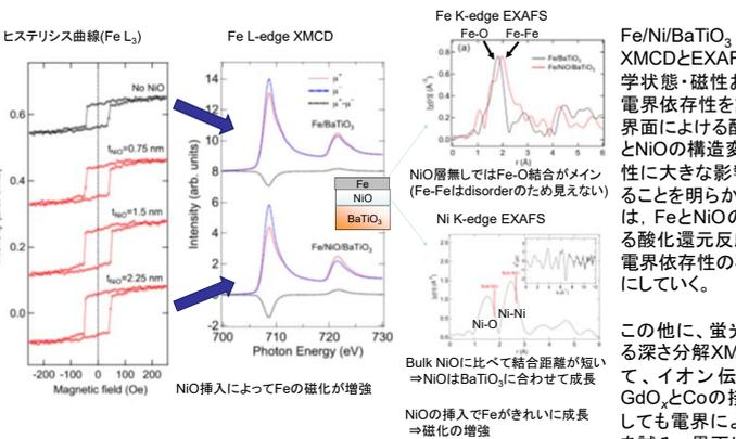
Fe/Ni/BaTiO<sub>3</sub> について、XMCDとEXAFSを用いて化学状態・磁性および構造の電界依存性を調べた結果、界面における酸化還元反応とNiOの構造変化がFeの磁性に大きな影響を与えていることを明らかにした。今後は、FeとNiOの界面における酸化還元反応に注目して、電界依存性の機構を明らかにしていく。
