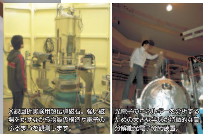
X線回折実験用超伝導磁石。強い磁場をかけながら物質の構造や電子のふるまいを観測します。
