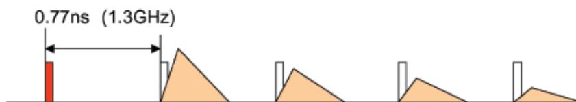
図 2.45: 電子バンチのタイミング (0.77 ns 間隔) とサブナノ秒検出器の応答。出力波高が時間によって変化していく場合を示す。
