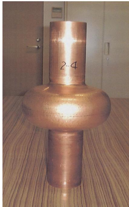
図 3.35: KEK で開発に成功した 1300 MHz のニオブ / 銅クラッド・シームレス単セル空洞。
