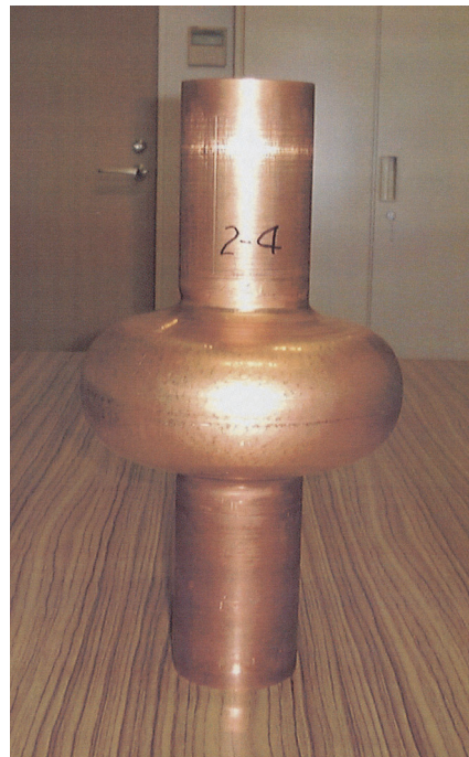
図 3.35: KEK で開発に成功した 1300 MHz のニオブ / 銅クラッド・シームレス単セル空洞。
