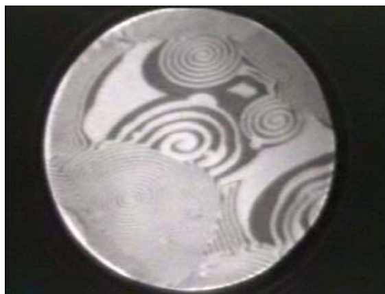
図1 Pt(110)表面上のCO酸化反応のPEEM像 黒い部分がO吸着、灰色がCO吸着 1)
