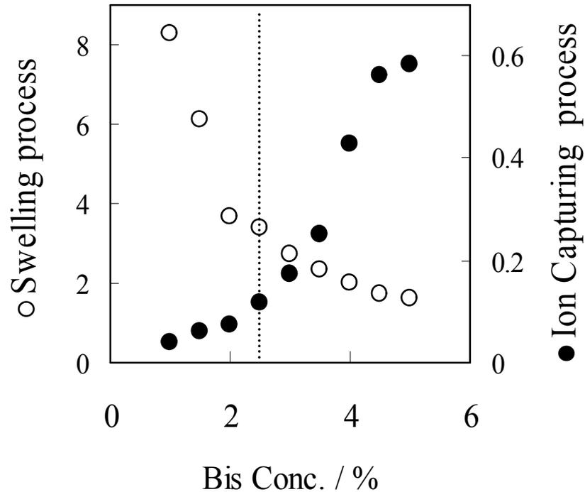
PAAm/SA (500mM /200mM)ゲルの純水中における膨潤過程 (○)と  $\text{Cu}^{2+}$ 吸着に伴う収縮過程 (●)における体積の [変化後/変化前] 比の架橋剤濃度依存性。
